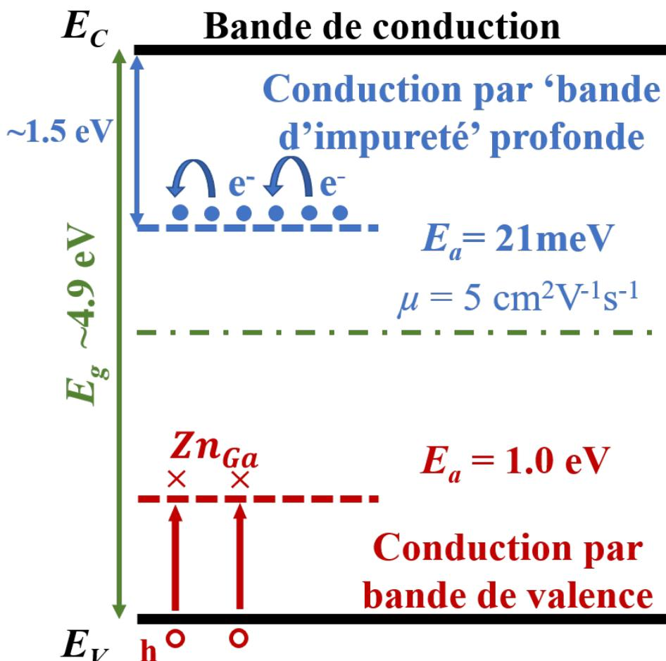
Figure : à gauche : diagramme de bandes indiquant les mécanismes de conduction de  $\text{ZnGa}_2\text{O}_4$  de type n (saut à distance variable ou au voisin le plus proche) par la « bande d'impuretés » générée par l'hybridation Zn-O, et également de type p (par la bande de valence par les défauts anti-sites).
