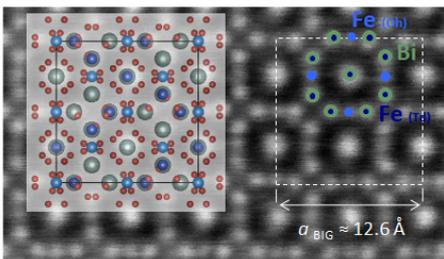
La maille de  $\text{Bi}_3\text{Fe}_5\text{O}_{12}$  avec la projection de la structure cristalline
